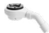
DIANA Tempoplex Funktionseinheit Ablaufgarnitur 90, DN 40 ohne Abdeckhaube, Universal-Abgang 40/50 mm mit 45° Ablaufbogen, für Brausewannen mit 90 mm Ablaufloch, (DI485130) 60,90 € Ausführung flach, (DI485131) 56,70 €
